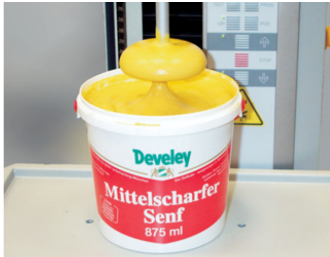
Bild 2: Viskositätsmessung direkt im Gebinde
