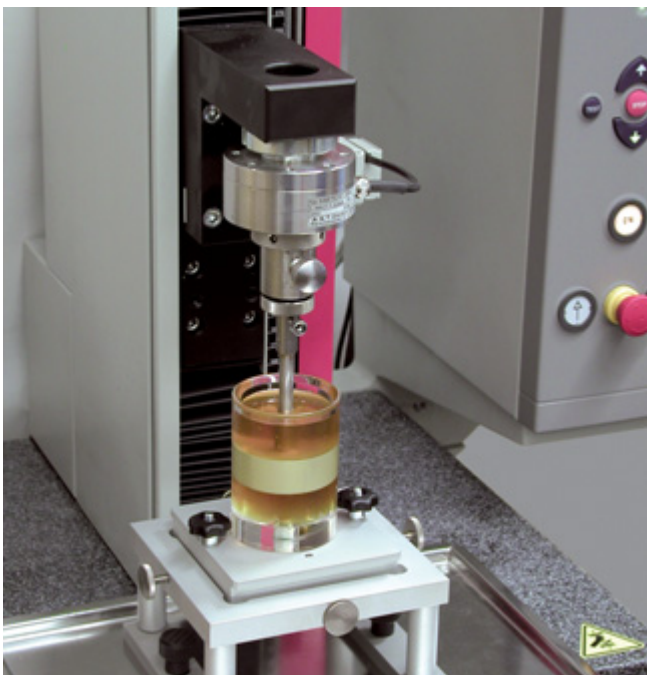
Bild 1: Die Zwick Roell Rückextrusions-Vorrichtung
